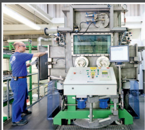
Abb. 3: Stückgutanlage für die Platinbeschichtung (Werksbild Umicore Galvanotechnik Schwäbisch Gmünd, 2017)
