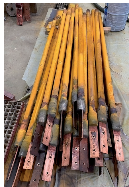
Eine Verringerung des Abstands zwischen Anode und Kathode ist bei Bleianoden aufgrund von Verformungen nur bedingt möglich (Bild: Umicore)
