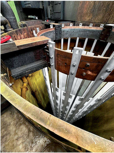
Anfang 2023 wurden bei der Wilhelm Bauer GmbH & Co.KG maßgeschneiderte Anoden mit einer beeindruckenden Länge von über sechs Metern installiert, wodurch sich der Stromverbrauch pro Jahr um 87 121 kWh und der CO 2 -Fußabdruck um 63,8 Tonnen reduziert haben (Bild: Umicore)
