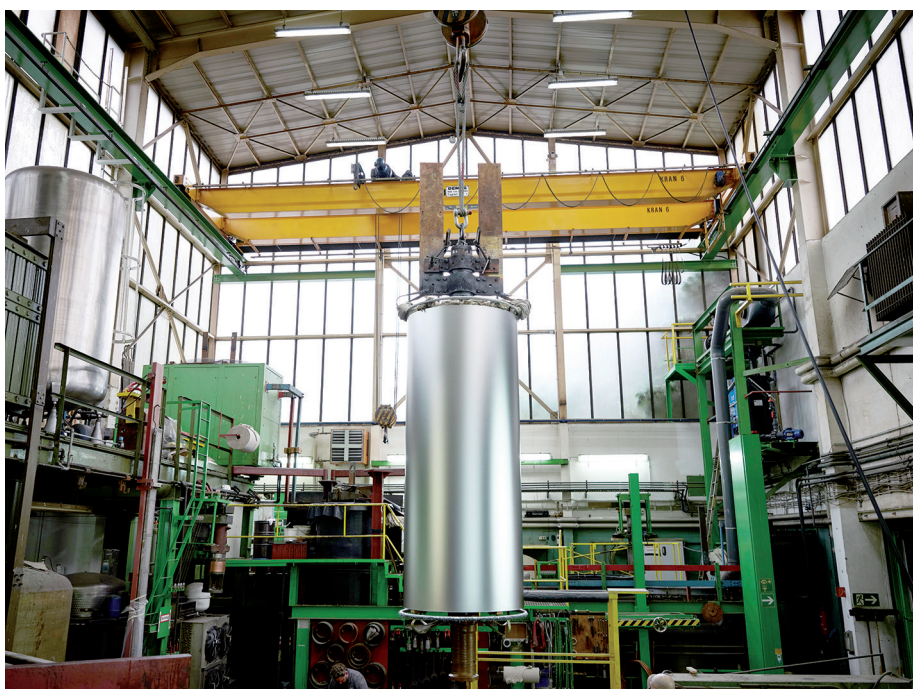
Bei der energieintensiven Hartverchromung von zum Beispiel Gießwalzen ist die PLATINODE® HC durch eine mögliche staatliche Förderung, Energieeinsparung und das Entfallen der Entsorgung von Bleichromat bereits nach etwa 2 Jahren wirtschaftlicher als Bleianoden (Bild: Umicore)
