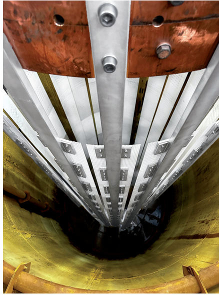
Anfang 2023 wurden bei der Wilhelm Bauer GmbH & Co.KG maßgeschneiderte Anoden mit einer beeindruckenden Länge von über sechs Metern installiert, wodurch sich der Stromverbrauch pro Jahr um 87 121 kWh und der CO 2 -Fußabdruck um 63,8 Tonnen reduziert haben (Bild: Umicore)
